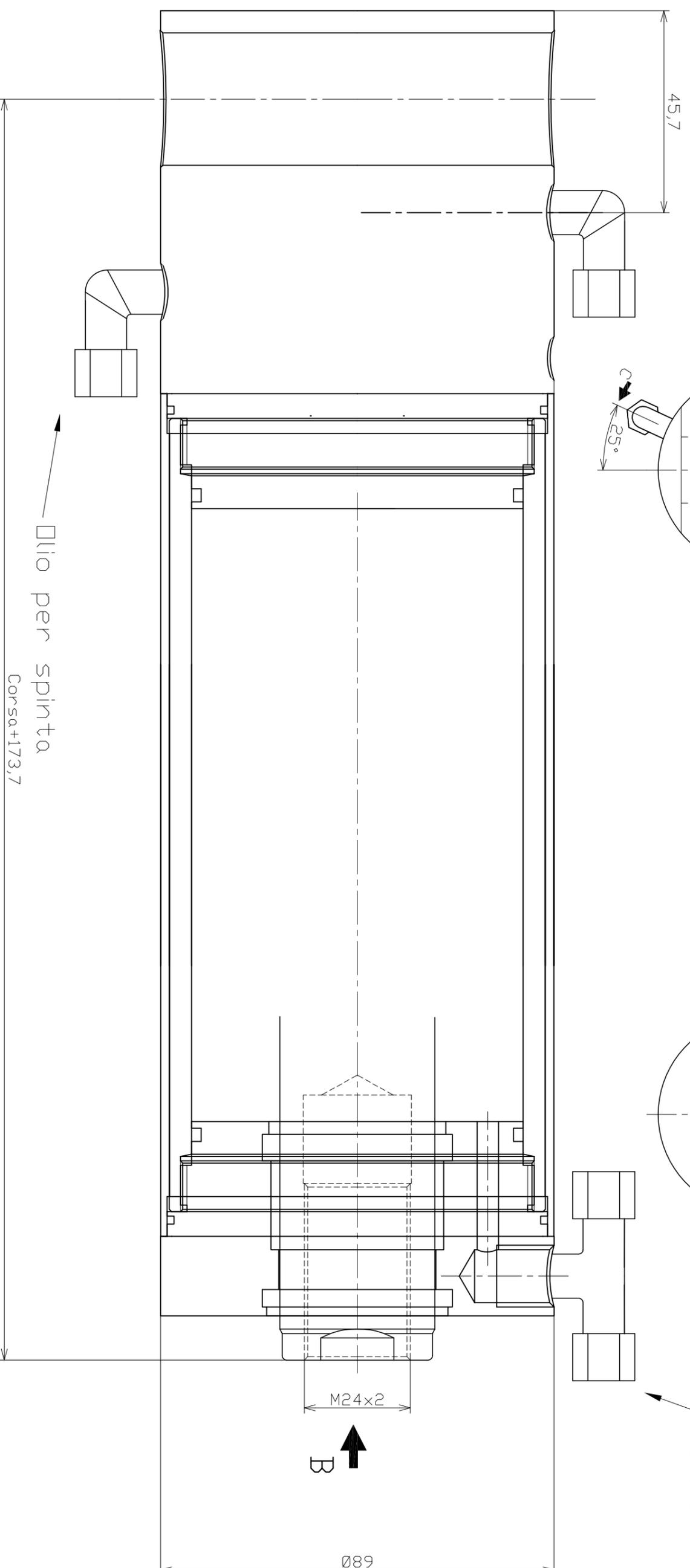
Cilindro con valvola di blocco integrata nel fondello.
